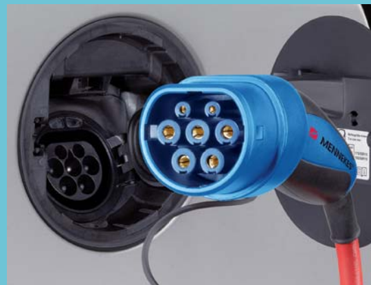
Sähköauton lataus on tarkoitettu tehtäväksi varsinaises- ta sähkölatauspisteestä. Niissä on kahta standardia, eu- rooppalainen Mennekes (tai tyyppi 2, kuvassa) tai japa- nilainen Yazaki (tyyppi 1/SAE J1772). EU on säätänyt di- rektiivin, joka määrittelee Mennekes-tyypin EU:ssa käy- tettäväksi standardiliittimeksi.
